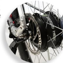
Freins à disque hydrauliques à 4 pistons sur disques ø180 mm. Capteur interactif qui met le moteur en veille lors du freinage
